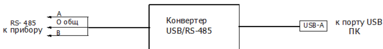
Рисунок 2 - Схема подключения конвертера USB/RS-485G
